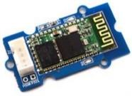
Brancher le module de communication Bluetooth sur la broche D2 du shield Grove.
